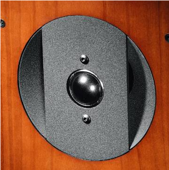
Sehr ungewöhnlich: Der Hochtöner ist auf einem Steg über der Bassreflexöffnung montiert.
